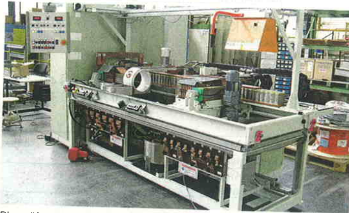
Rissprüfmaschine der Firma ITW Tiede.
